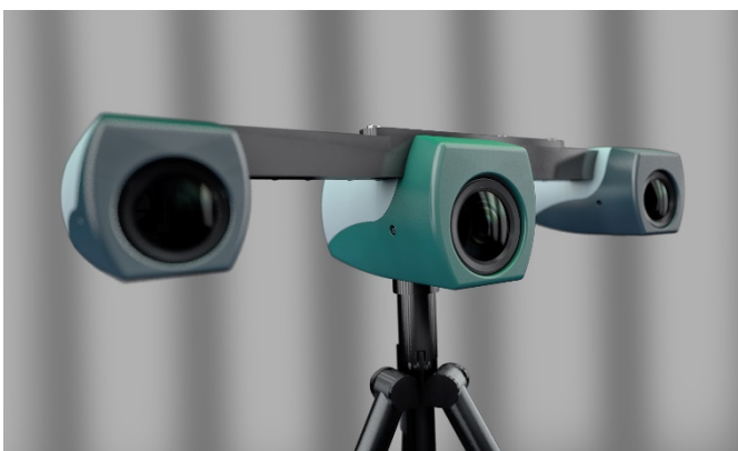
Abb. 2 3D-Sensorik: Zwei Hochgeschwindigkeitskameras sowie ein Goboprojektor ermitteln die 3D-Daten der sich bewegenden Person.
